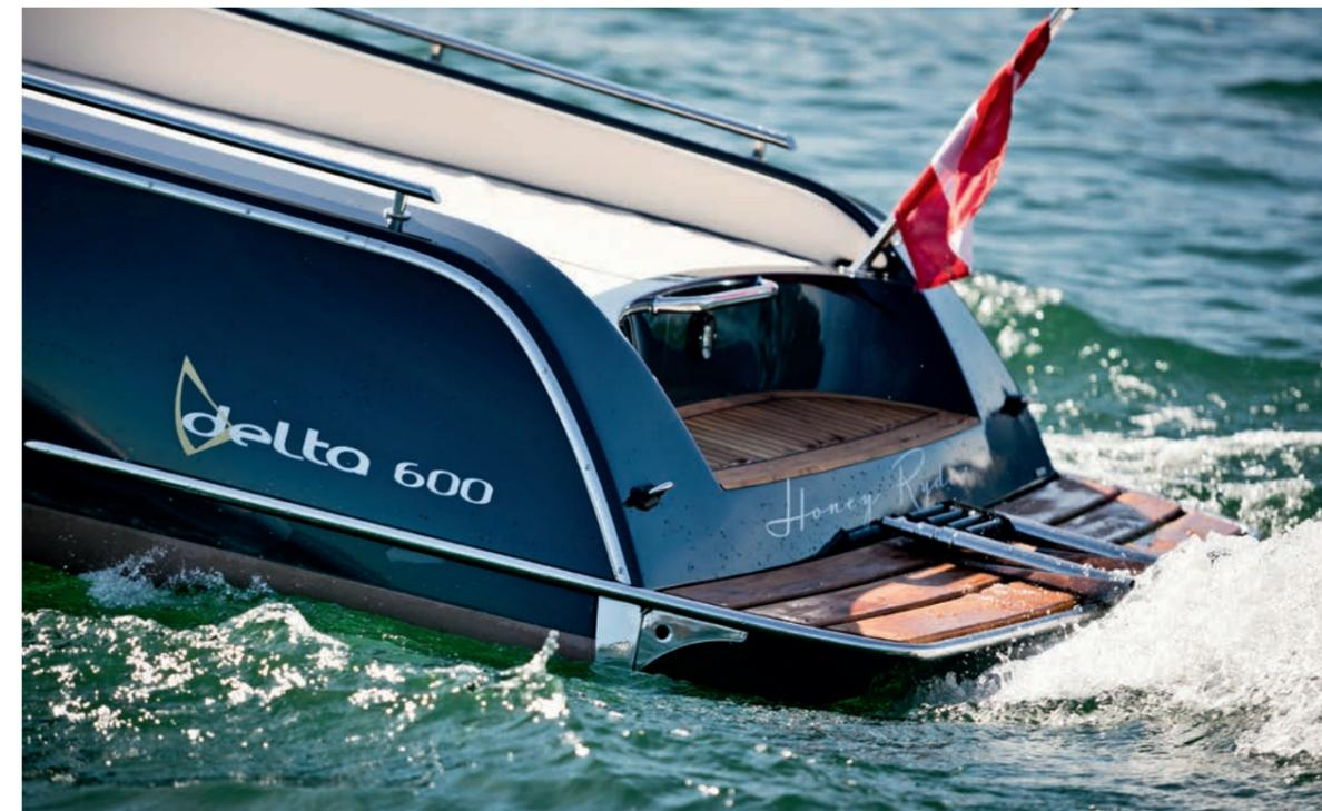
Der Elektromotor des Delta 600 bietet abgas- und ölfreies sowie beinahe geräuschloses Fahrvergnügen. Erleben Sie herausragende Fahreigenschaften durch die lenkbaren, getriebelosen Unterwasserantriebe neuester Technologie. Diese zeichnen sich durch höchste Wirkungsgrade und extreme Laufruhe aus, bei einer Motorisierung von 3,5 kW bis 8 kW. Wartungsfreie, langlebige AGM Deep Cycle Batterien ergänzen das innovative Technikpaket.
